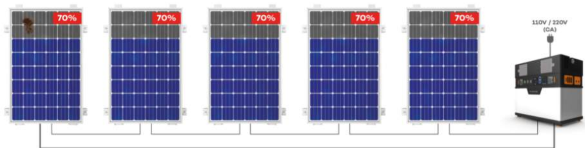
Figura 8 - Sujidade no painel limitando a geração da string
