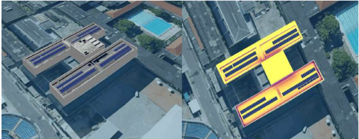
Figura 19 - Modelagem 3D e renderização de sombreamento no SolarEdge Designer
