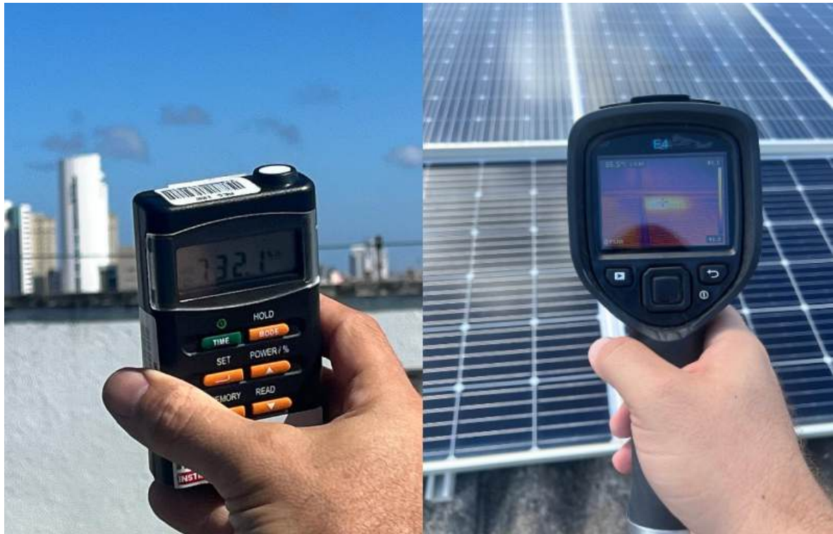
Figura 18 - Termografia e medição de irradiância solar “ Modelo câmera Flir E4”
