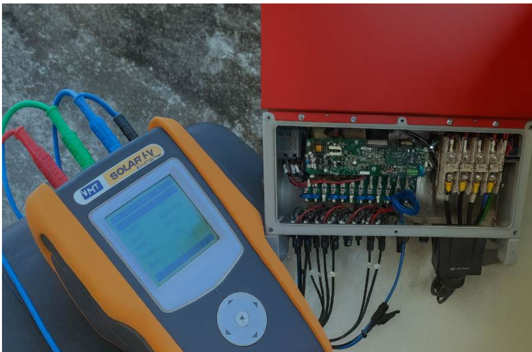
Figura 17 - Traçador de Curva I-V “HT modelo I-V500w SOLAR I-Ve” em ensaio
