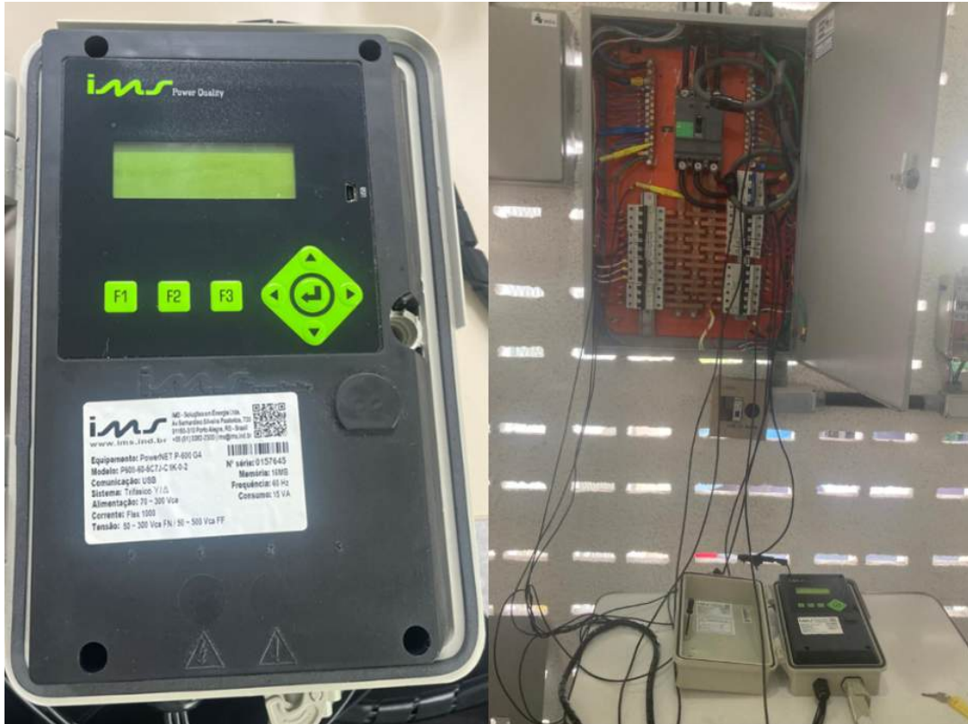
Figura 16 - Analisador de energia “IMS modelo P600” em ensaio
