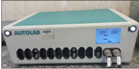
Figura 17 — Potenciostato/galvanostato Autolab modelo PGSTAT302N da Metrohm
