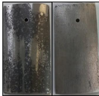
Figura 12 — Corpo de prova usado no teste de perda de massa
