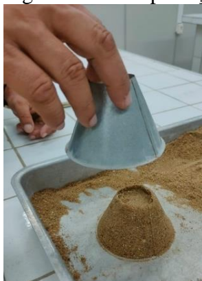
Figura 17 - Compactação do agregado miúdo no tronco de cone
