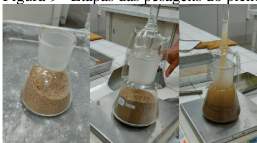
Figura 9 - Etapas das pesagens do picnômetro
