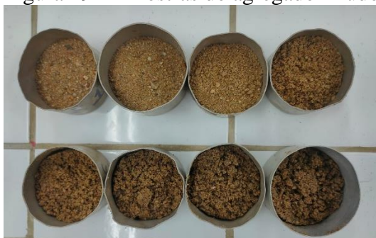
Figura 19 - Amostras do agregado miúdo com diferentes porcentagens de umidade
