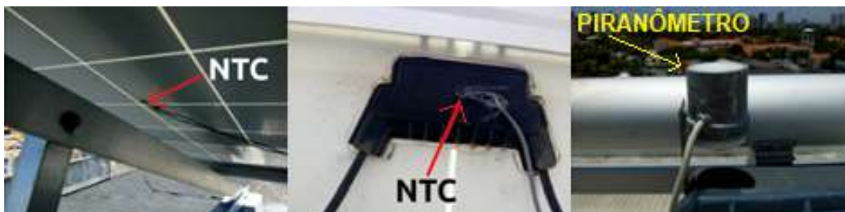
Figura 16 - Sensores utilizados para leitura de dados.
