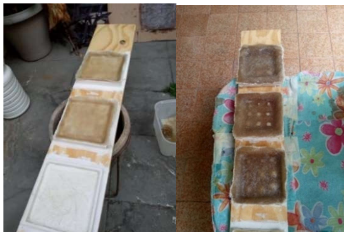
Figura 33 – Confeção das amostras GFRP nos moldes
