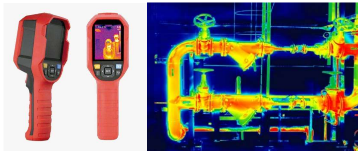
Figura 6 – Câmera termográfica à esquerda e imagem termográfica à direita
