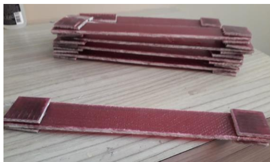
Figura 3.7. Amostra pronta para ensaio de tração.
