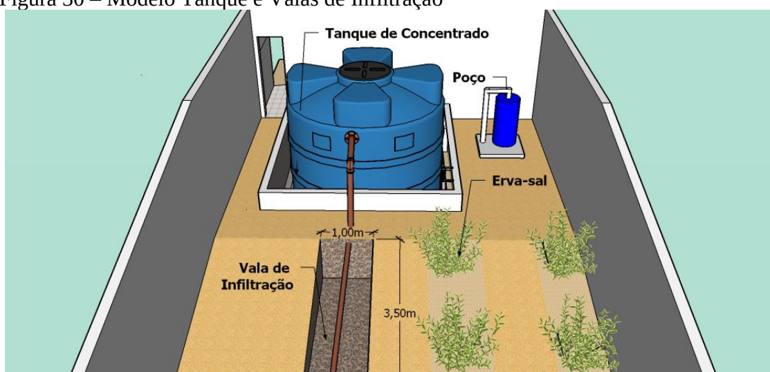
Figura 30 – Modelo Tanque e Valas de Infiltração
