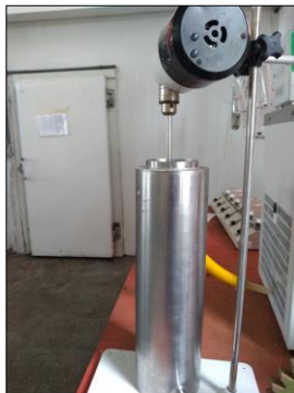
Figura 08 – Reator utilizado para obtenção do extrato de noni.
