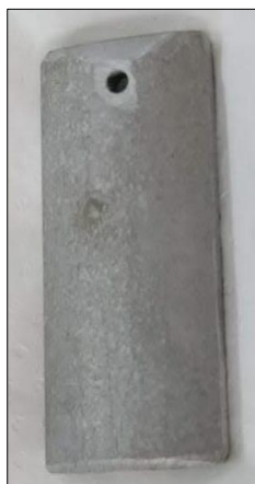
Figura 10 - Corpo de prova utilizado no ensaio de perda de massa
