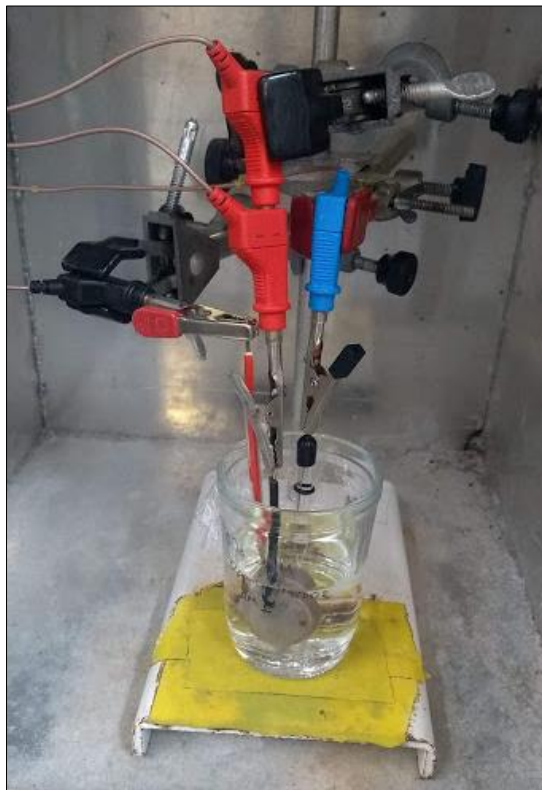
Figura 12 - Sistema convencional composto por três eletrodos, utilizado para os ensaios eletroquímicos.
