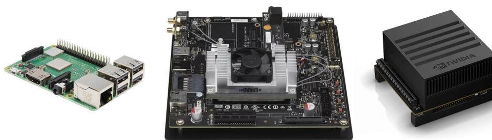
Figura 1 – Plataformas: Raspberry PI3(esquerda), Nvidia TX2 (centro) e Xavier (direita).
