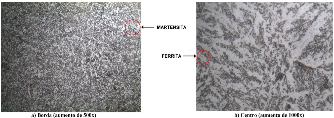
Figura 4.31 Fotomicrografia Borda e Centro do Aço 4340
