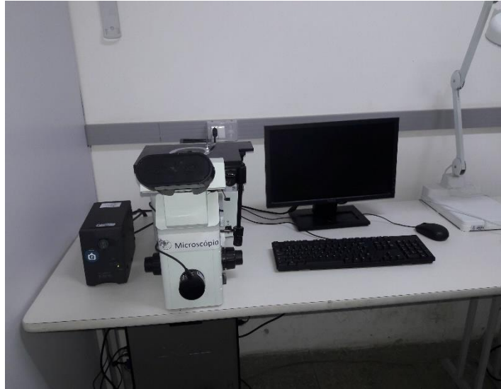
Figura 3.2 Microscópio Óptico Olympus GX 51 e Computador para Capturar as Imagens
