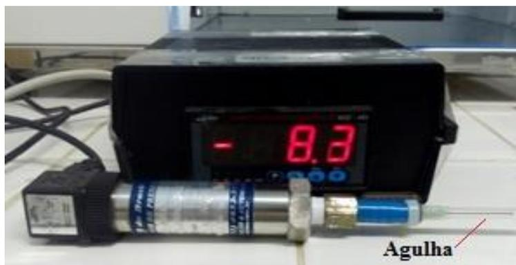
**Figura 6** - Manômetro digital em mbar
