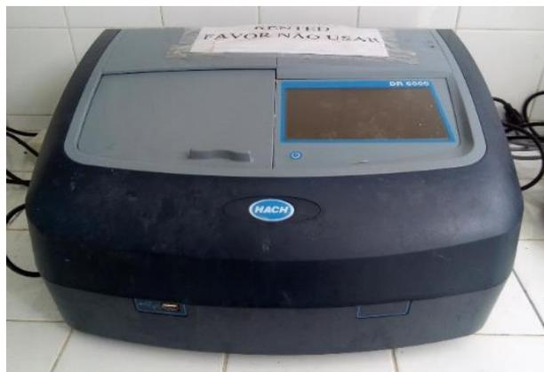
**Figura 17** - Espectrofotômetro utilizado nas análises de DQO
