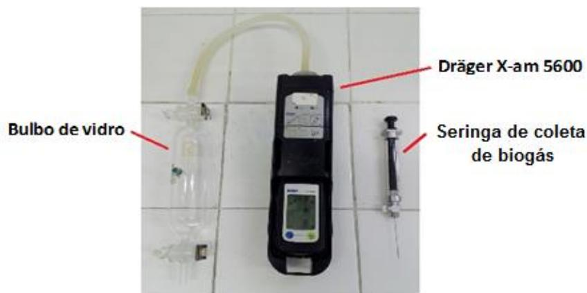
**Figura 16** - Equipamento de medição de  $\text{NH}_3$  e  $\text{H}_2\text{S}$
