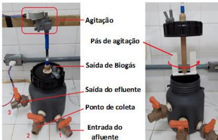
**Figura 9** - Biorreator anaeróbio semicontínuo e sistema de agitação
