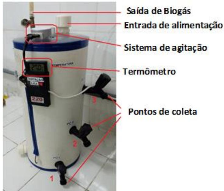
**Figura 7** - Biorreator anaeróbio em batelada
