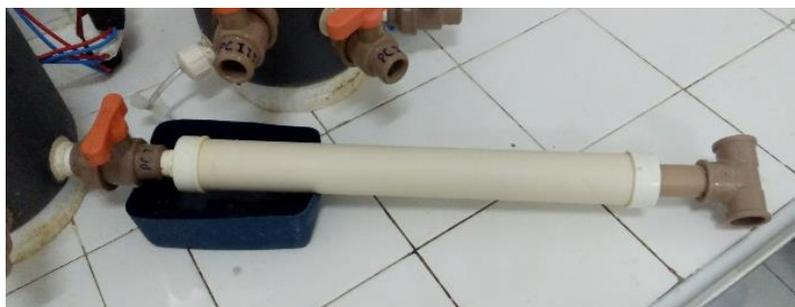
**Figura 10** - Seringa usada na alimentação dos reatores semicontínuo
