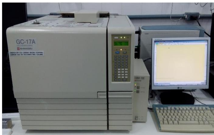
**Figura 15** - Cromatógrafo gasoso (CG - 17A)
