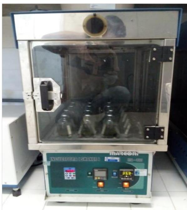
**Figura 5** - *Shaker* orbital utilizado no teste de AME
