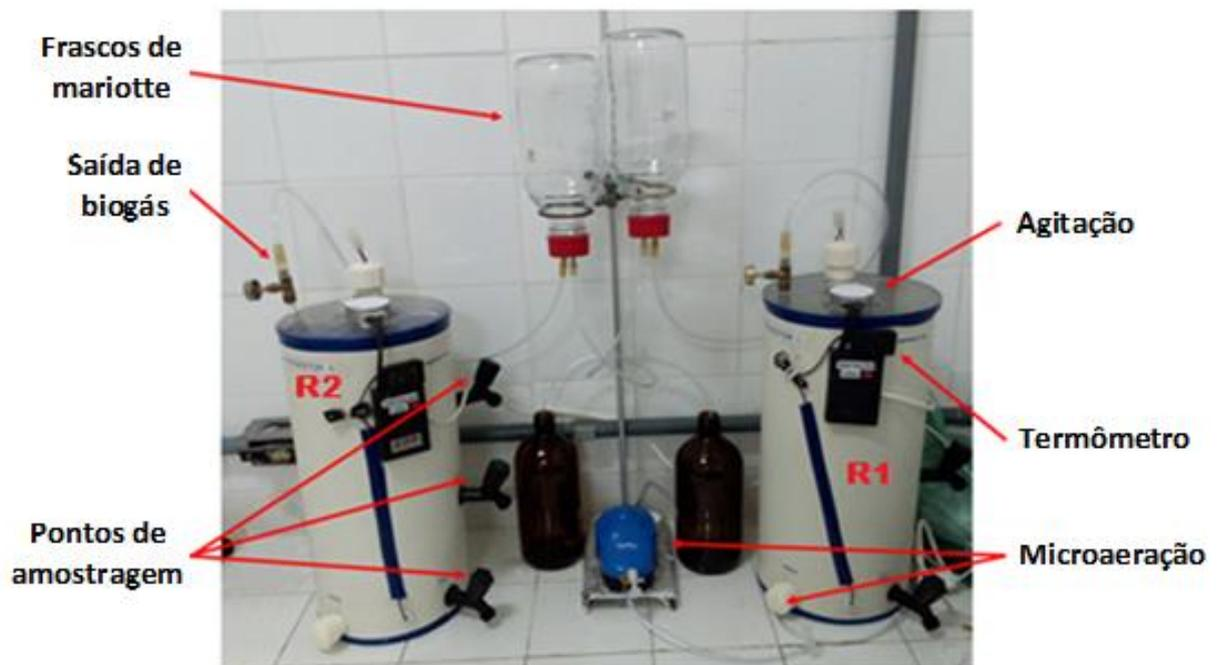
**Figura 8** - Reatores anaeróbios em batelada (Experimento 1)
